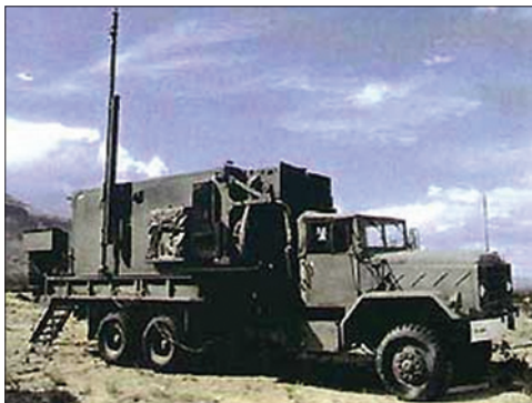
Пункт управления огнем (КП батареи) ЗРК «Пэтриот»
