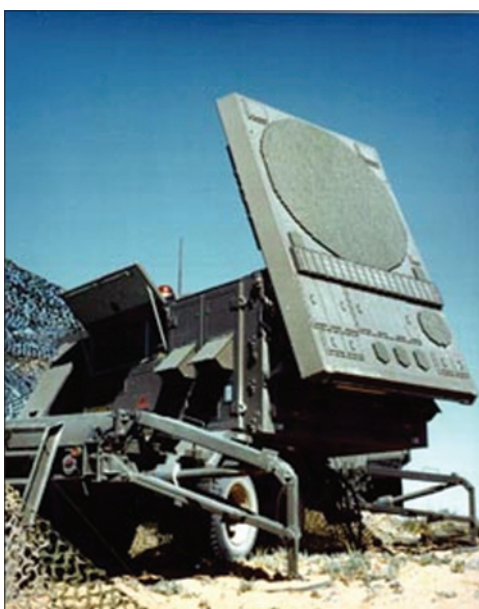
Многофункциональная РЛС AN/MPQ-53
