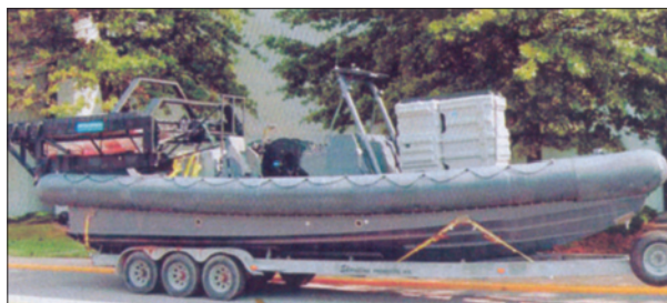
Катер RHIB с испытываемой ГАС AQS-24 на трейлере
