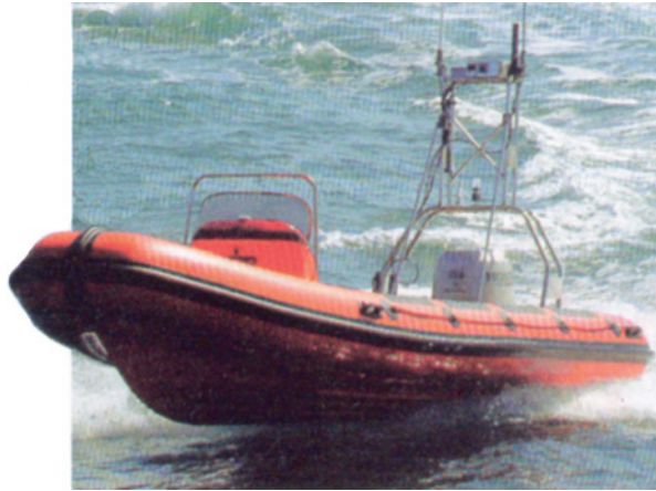
Английская надувная лодка, переоборудованная в ДУКА с системой управления с автопилотом ЗОМС
